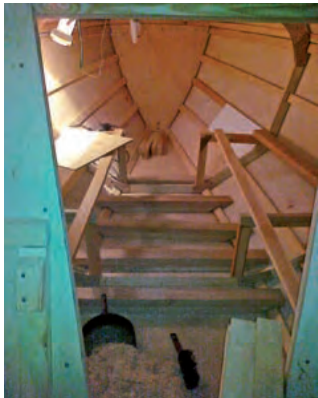
Kadłub od środka, widać w gruncie rzeczy jak delikatna jest konstrukcja.
