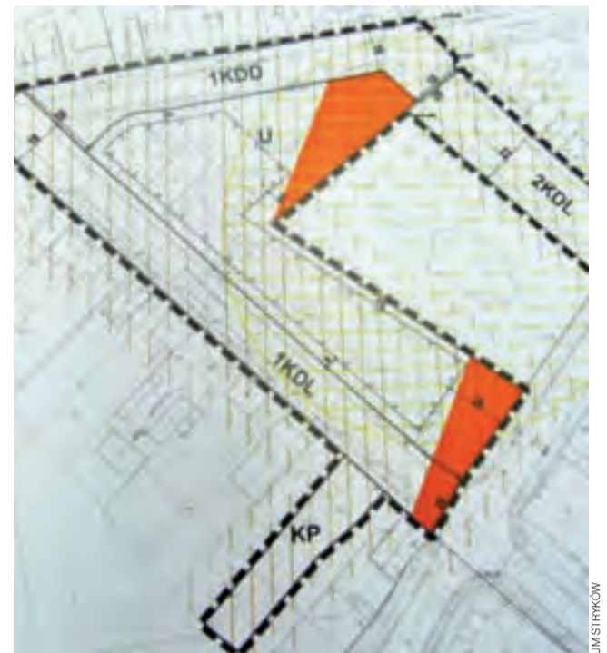
Załącznik graficzny do podjętej uchwały. Kolor pomarańczowy oznacza strefy ekspozycji dla kościoła, KP – ciąg pieszy z miejscem do parkowania przy ul. Kościuszki, 1KDL – drogą lokalną ul. Kościuszki, 2KDL – drogą lokalną Pl. Łukasieńskiego, 1KDD – drogą dojazdową Pl. Łukasieńskiego.
