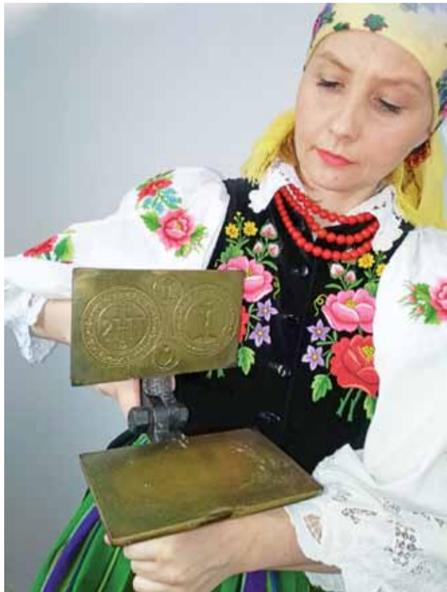
Matryca zamontowana w „żelazie”. Widać na niej wzory, które odciskane były w czasie produkcji hostii.
