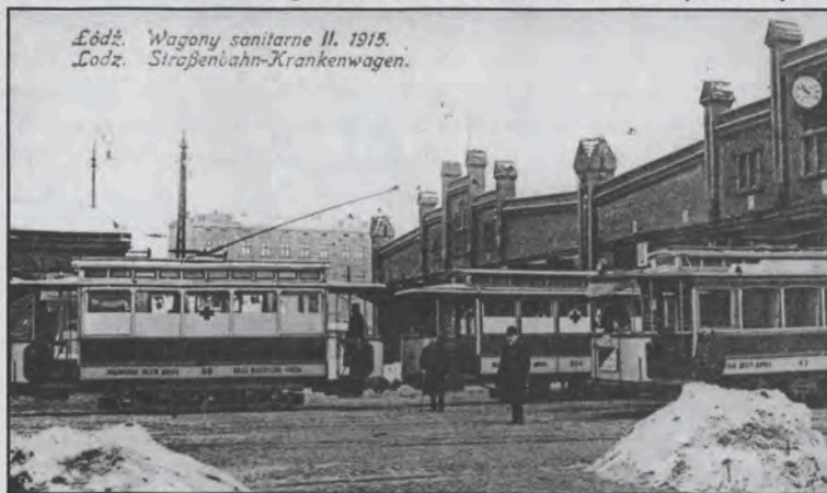
Jeden z dwóch zestawów wagonów sanitarnych KEŁ (tu silnikowy „Herbrand U-107c”, nr bocz. 88 oraz doczepek „ryśka”, nr bocz. 204). Powstały z adaptacji normalnych wagonów tramwajowych. Zdjęcie wykonane w lutym 1915 r. na terenie zajezdni przy ul. Tramwajowej. Tu na pocztówce wydanej w 1917 (?) r. jest to jedyne znane zdjęcie tych wagonów.
