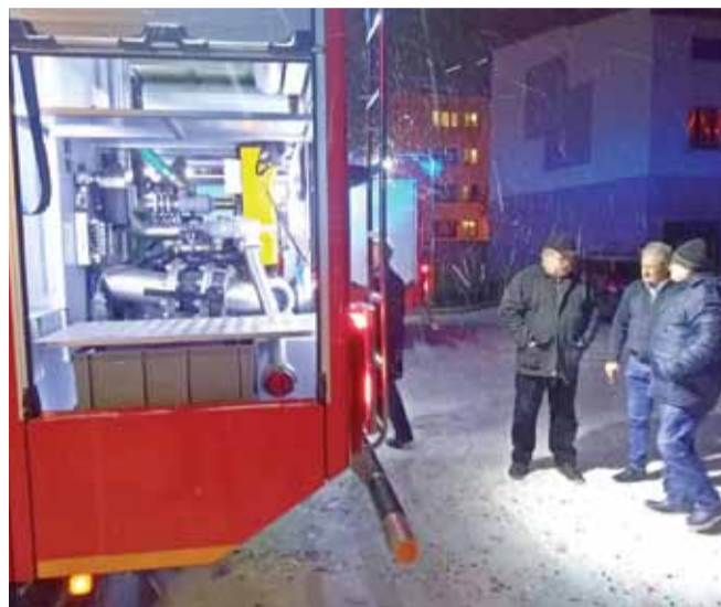
Jednym z atutów, choć nie jedynym, nowego samochodu strażackiego OSP Łowicz jest wysokowydajna pompa, która jest w stanie przepompować 4 tysiące litrów wody w ciągu jednej minuty.
