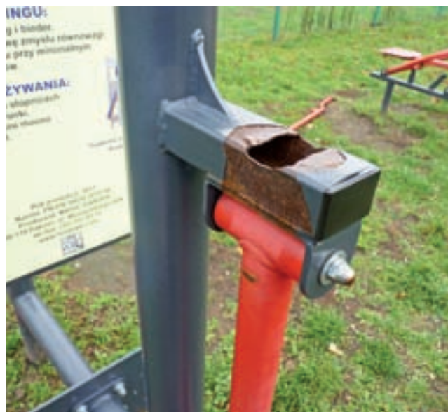
Urwana poręcz od biegacza. Widać, że materiał, z którego wykonano urządzenie też jest marnej jakości
