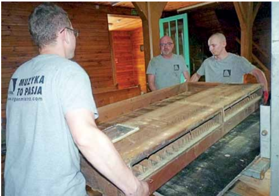
Fachowcy z firmy Organmistrzostwo Andrzeja Sutowicza zabierają do renowacji serce instrumentu, czyli wiatrownicę klapowo-zasuwową organów.
