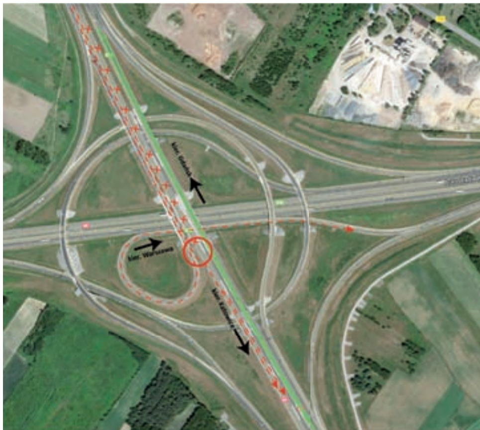
Czerwone krzyżyki obrazują zamknięte drogi, czerwone kreski drogę, którą prowadzeni są kierowcy jadący od północy, od strony Kutna. Czerwone kółko pokazuje miejsce, gdzie zbudowano prowizoryczny przejazd z wiaduktu zjazdowego na Warszawę z powrotem na główną nitkę autostrady w stronę Katowic.
