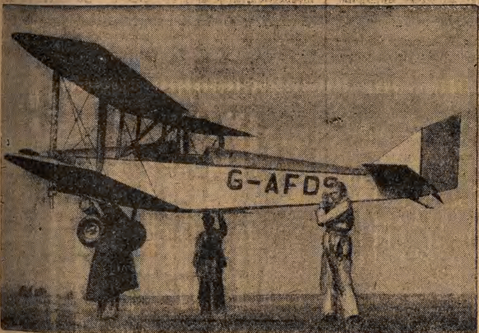
Ein leichtes Flugzeug von 120 Kilometer Stundengeschwindigkeit, das wenig Benzin verbraucht und nur 180 Kilogramm wiegt, wurde in England hergestellt
