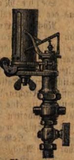
**Patent-Indikator** mit verbesserter Schreibstiftführung nach Rosenkranz und bewährter Anhaltevorrichtung der Papiertrommel im Betriebe.
