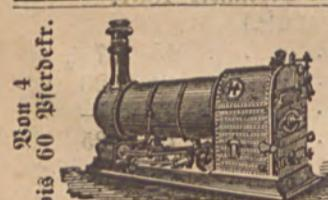
Für kleine Anlagen empfehle ich die daneben abgebildete halbtransportable Locomobile. Die Maschine liegt auf einem starken Fundamente, der Gang ist daher sehr ruhig. Das Speisewasser wird in einem Vorwärmer in hohem Grade erwärmt, bevor es nach dem Kessel gelangt. Dieser Vorwärmer befindet sich in der Fundament-Platte. Es genügt ein kleiner Schornstein, welcher von der Fabrik mitgeliefert wird.
