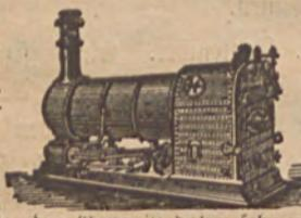
Für kleine Anlagen empfehle ich die daneben abgebildete halbtrans-portable Locomobile. Die Maschine liegt auf einem starken Fundamente, der Gang ist daher sehr ruhig. Das Speisewasser wird in einem Vorwärmer in hohem Grade erwärmt, bevor es nach dem Kessel gelangt. Dieser Vorwärmer befindet sich in der Fundament-Platte. Es genügt ein kleiner Schornstein, welcher von der Fabrik mitgeliefert wird.
