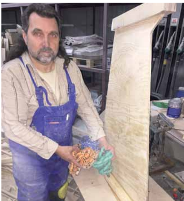
Modele elementów stalowych, których wykonanie zleci na zewnątrz – jak widocznej na zdjęciu płetwy stabilizacyjnej, która będzie umieszczona pod dnem tuż przed płetwą sterową – Marcin Klimczak wykonuje osobiście, ze sklejk.
