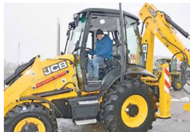
Koparko-ładowarka JCB 3CXECO ma służyć m.in. do wiosennej naprawy odcinków gruntowych
