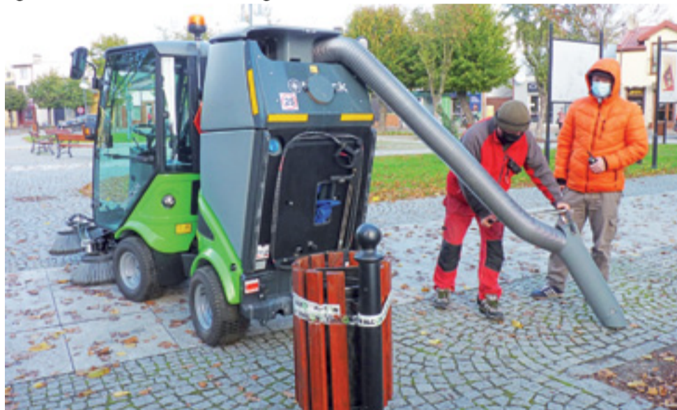
Kompaktowa maszyna komunalna umożliwia m.in. odkurzanie trudno dostępnych miejsc.
