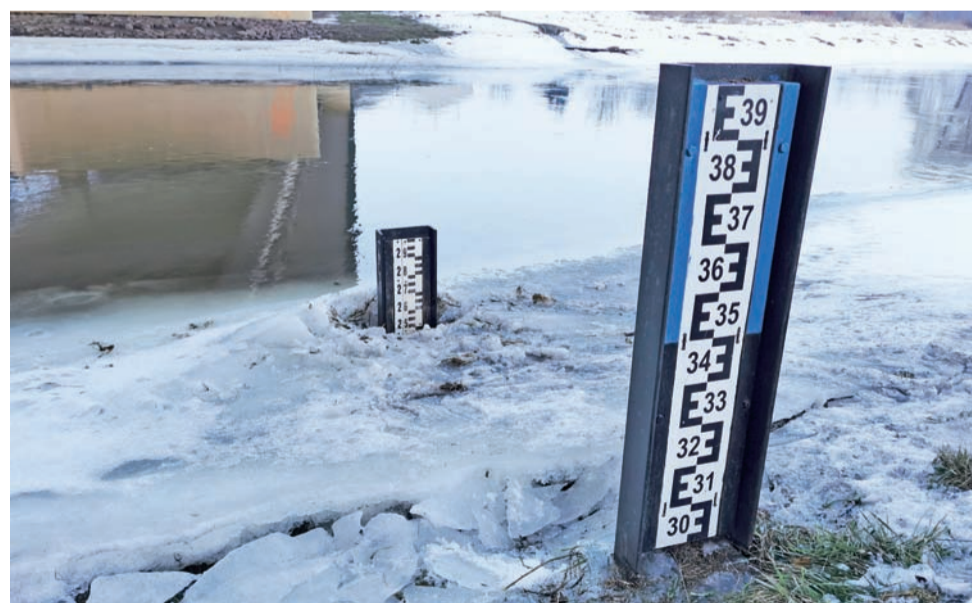
Poziom wody na Bzurze można śledzić z wodowskazu przy moście w ciągu ulicy Warszawskiej w Łowiczu.
