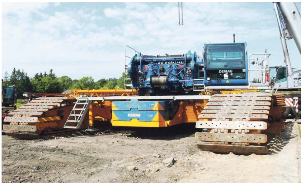
Szerokie gąsienice żurawia są w stanie przesunąć go w raz z uniesionym ładunkiem w terenie.
