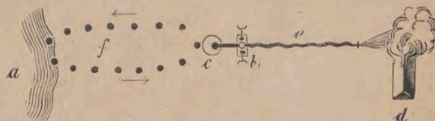
Rys. 5. Łańcuch wodny z ludzi: a — zbiornik wody, b — sikawka, c — zbiornik do wody, d — palący się budynek, e — linja węzowa, f — łańcuch wodny.
