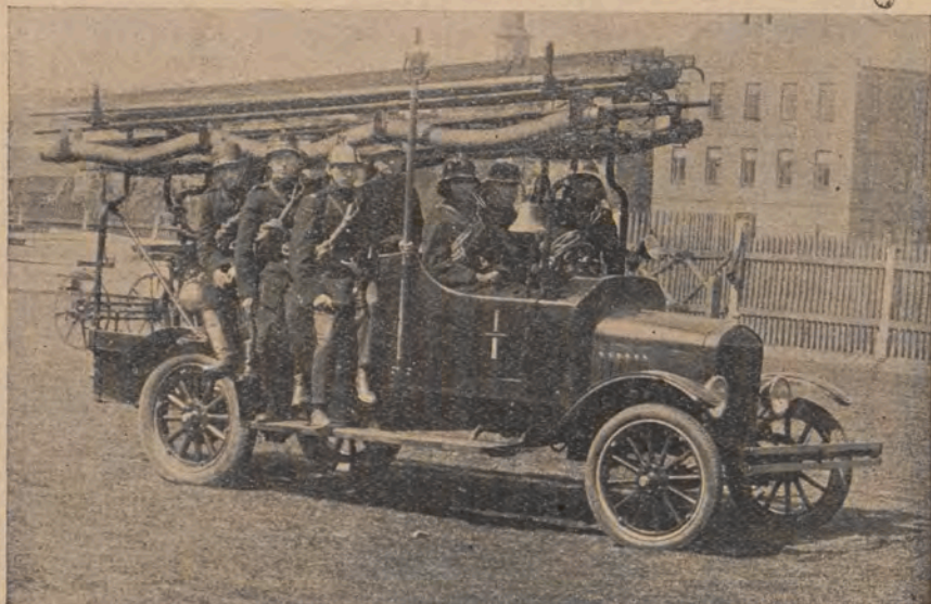
Pogotowie samochodowe „Florjan” Straży Radomskiej, wykonane w tej Straży na półciężarówce samochodzie „Ford”, posiada motorową sikawkę przenośną i płaski zbiornik na wodę.
