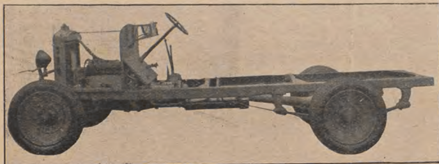
Podwozie ciężarowe „Ursus”, typ „A” — widziane z boku.
