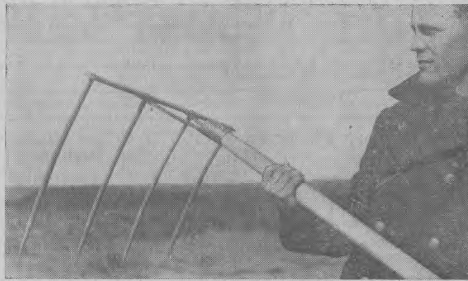
Specjalnie skonstruowane grabie, którymi nurkowie poszukują pod wodą resztek biskupińskiej osady bagiennej
