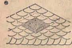
Bei Schieferdeckung genügt es meist, Dachpappe unterzulegen und anzunageln.
