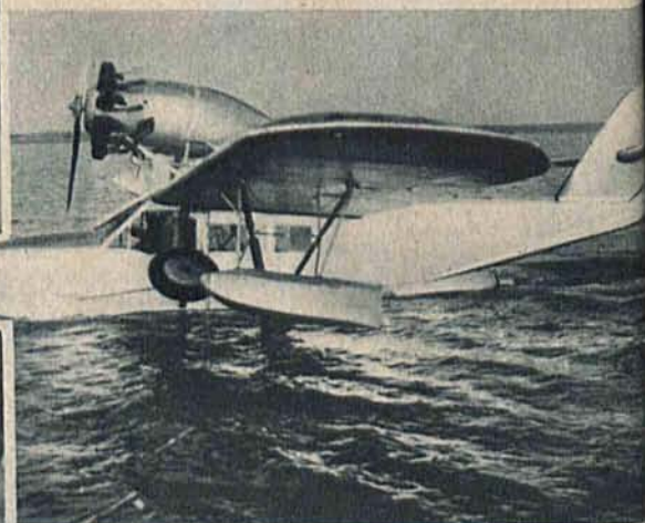
Samolot, który wywołał sensację na Wystawie Kacji powietrznej w Sztokholmie. Jest skonstruowany w sposób że może lądować na ziemi i na wodzie.
