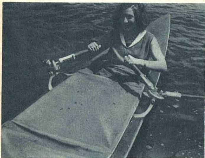
Nowy typ łodzi z wiosłami skonstruowanymi w ten sposób, że łódź może się posuwać wprzód, a nie jak dotąd wstecz.
