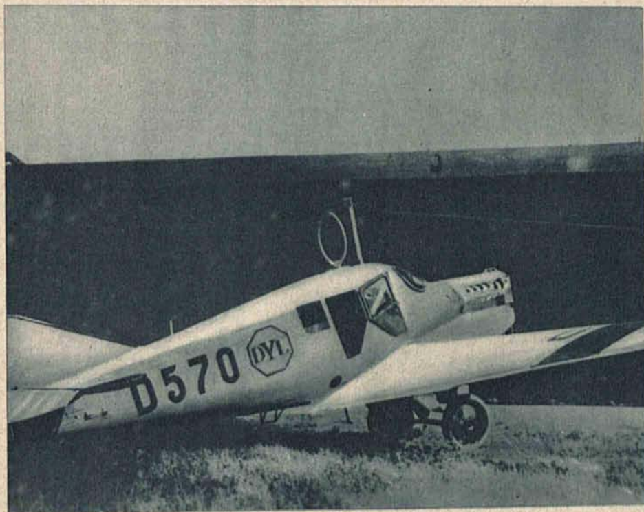
Aparatura z pionem zmontowana na samolocie pozwala orjentować się co do kierunku na wypadek złego funkcjonowania kompasu.
