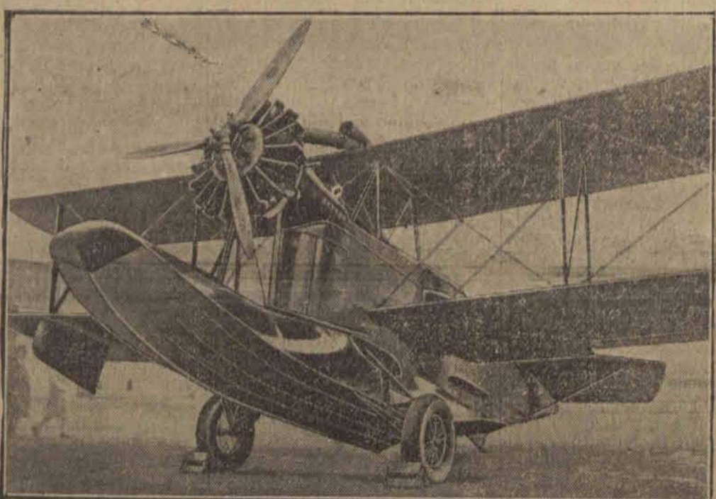
Nowy aparat zwycięzcy Atlantyku „Amfibian”, który może opuszczać się zarówno na lądzie, jak i na morzu, albowiem łódź zaopatrzona jest w koła.
