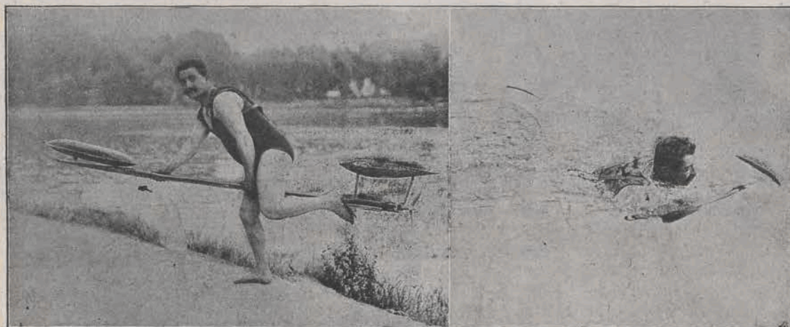
Motor do pływania. Dwa rezerwoary z powietrzem utrzymują pływaka na powierzchni. Dwoma pedałami porusza śrubę. W ten sposób można godzinami płynąć z szybkością 10 kil. na godzinę. Wynalazca jest francuzem.
