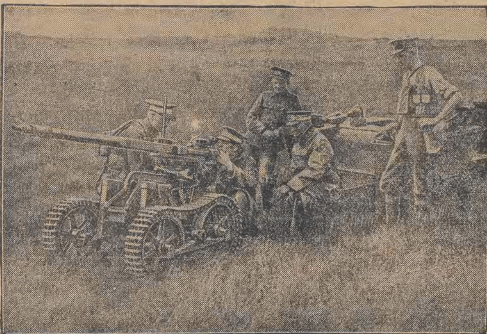
Armata do zwalczania czołgów ( tanków) zastosowana obecnie w armii angielskiej. Jak widzimy — porusza się ona również na łańcuchach, jak czołgi.
