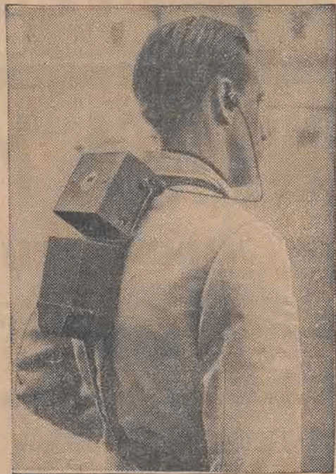
W Ameryce skonstruowano specjalny aparat radiowy, stale noszony na plecach, który użyty będzie w straży pożarnej, w kopalniach, w straży leśnej i t. d.
