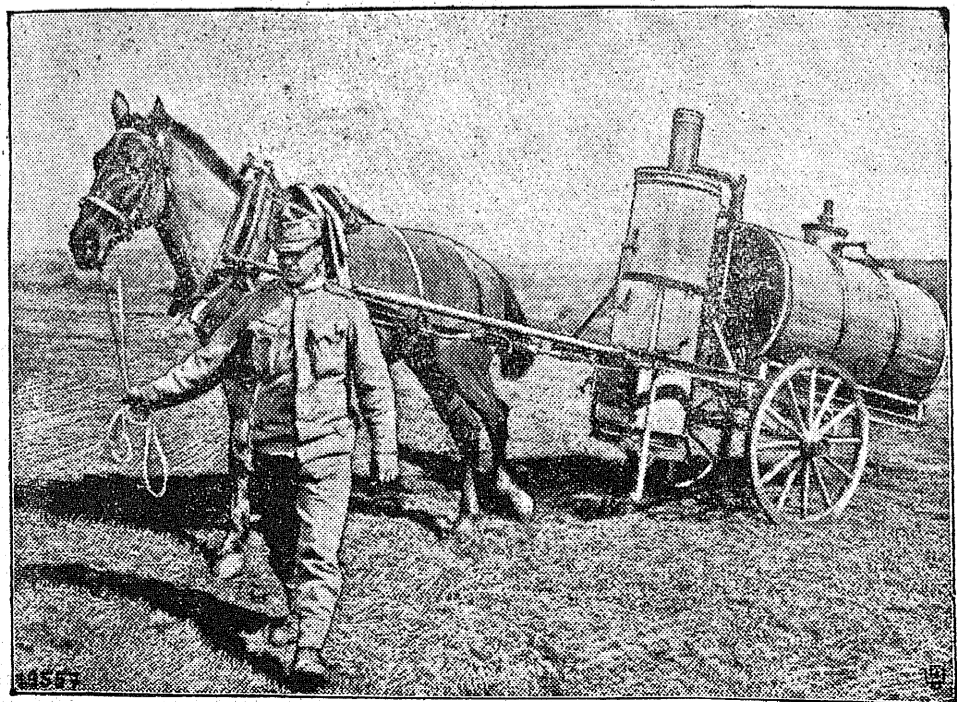
Fahrbarer Desinfektionsapparat für Kleider und Wäsche in Galizien.
