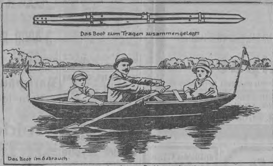
Das Boot zum Tragen zusammengelegt. Das Boot im Gebrauch. Ein zusammenlegbares Rettungsboot.
