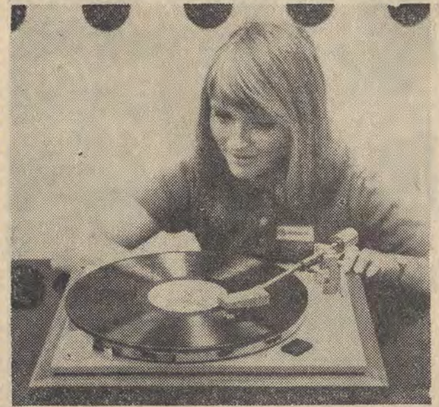
Wysokiej klasy gramofon stereofoniczny „Tonica” produkcji Łódzkich Zakładów Radiowych ze wzmacniaczem. Nowoczesne rozwiązanie układu rzmienna, o regulowanym nacisku na igłę 3-5 g. Automatyczne podnoszenie igły wyklucza zarysowanie płyty. CAF - Staszyszyn
