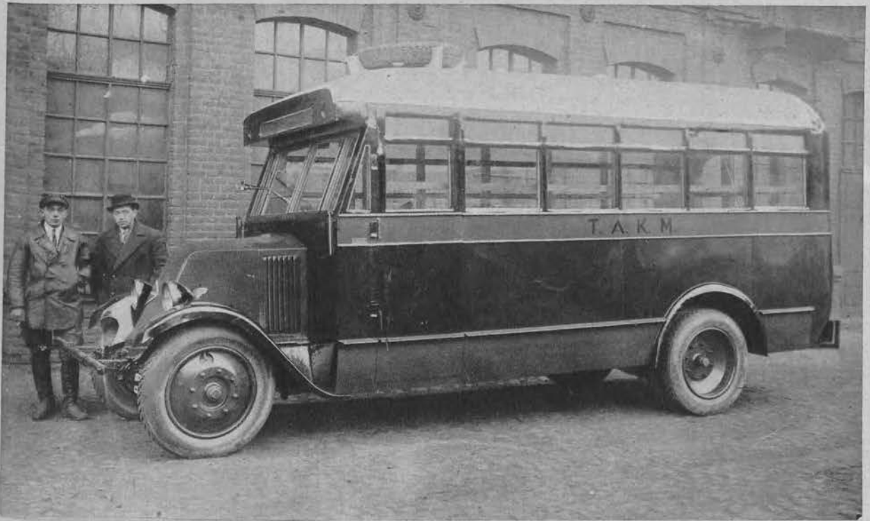
Nowy typ wozu Tomaszowskiej Autobusowej Komunikacji Miejskiej, budowany na podwoziu „Renault“ w fabryce karoserji Łuczaka.
