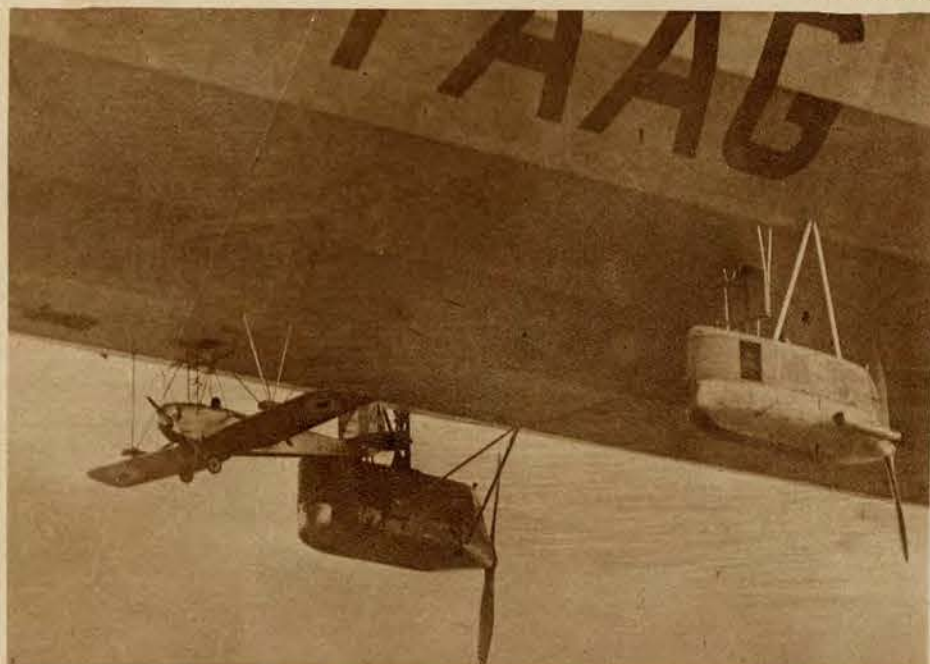
Na podobieństwo okrętów, dźwigających łódzie ratunkowe, wielkie sterowce powietrzne wyposażone są w pomocnicze aeroplany. Zawieszane u spodu balonu, mogą podczas lotu opuścić, przenieść pocztę lub pasażerów i ewentualnie wyratować załogę w razie nieszczęścia.
