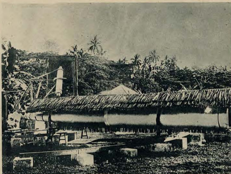
Olbrzymia horyzontalna kamera fotograficzna holenderskiej stacji doświadczalnej, badającej zaćmienie słońca na Sumatrze. Na prawo widoczny otwór na kasety z płytami, na lewo ustawione czarne lustro, chwytające odbicie słońca.
