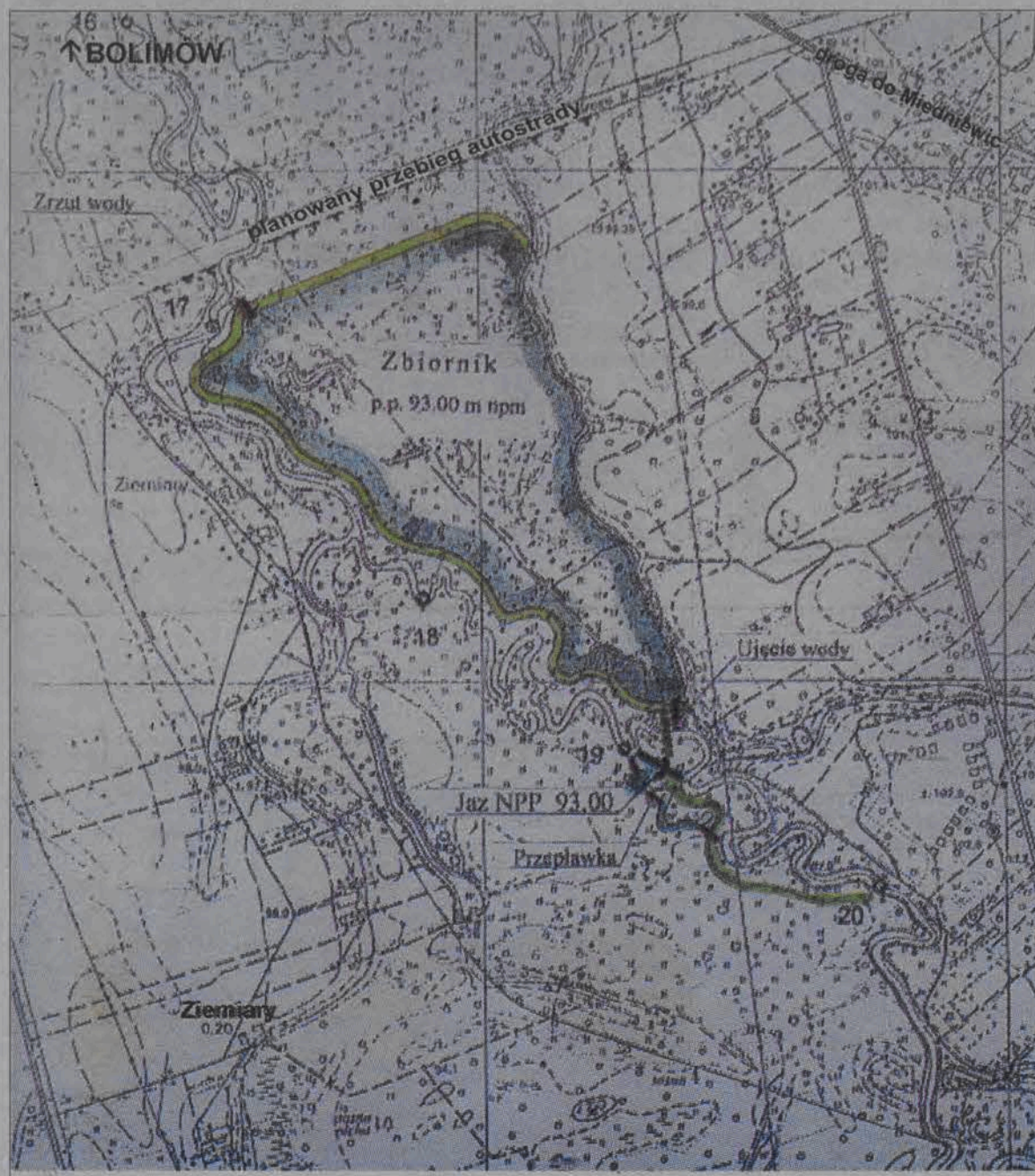
Zbiornik Joachimów-Ziemiany. Linia zielona - zaporę czołową i boczną, linia niebieska - zasięg zalewu.
