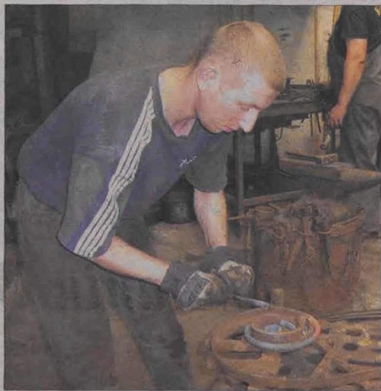
Rozgrzany do czerwoności stalowy pręt wyginany jest w formie.
