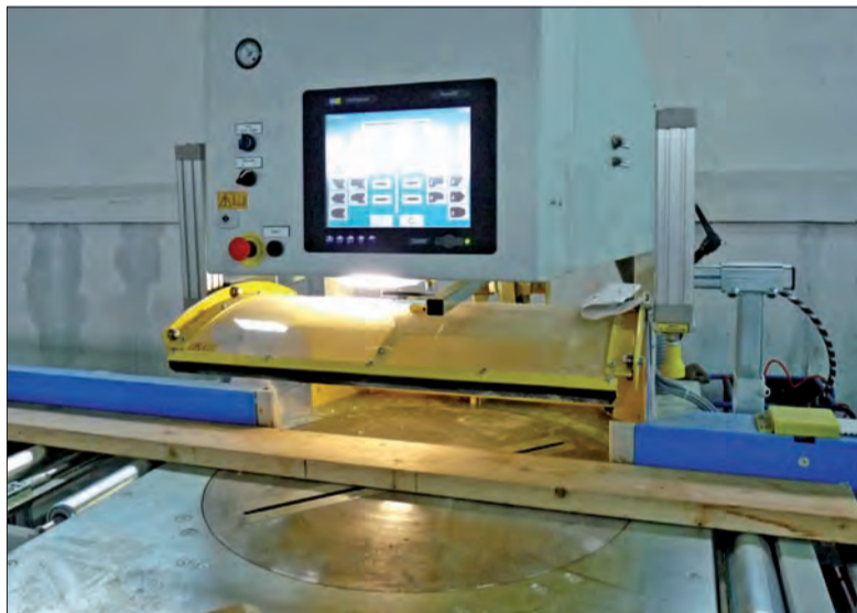
Na ekranie komputera sterującego pracą piły widać opcje różnego rodzaju cięć.
