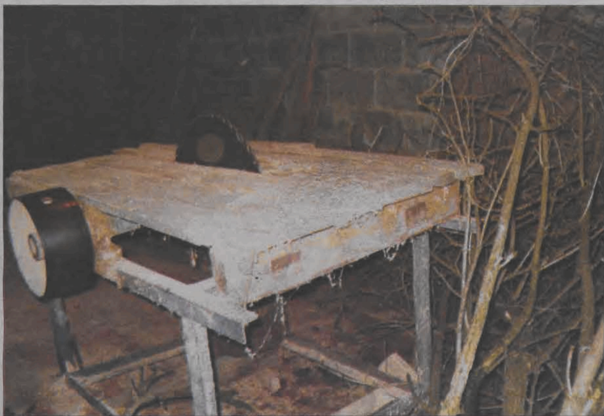
Tarczowa piła elektryczna jest niemal w każdym gospodarstwie. Problem w tym, że większość z nich nie ma osłon chroniących przed urazami.
