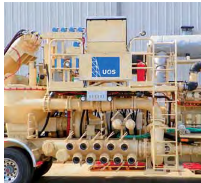
Jedno z urządzeń UOS odpowiedzialnych za pompowanie wody wykorzystywanej do szczelinowania pokładów łupków.
