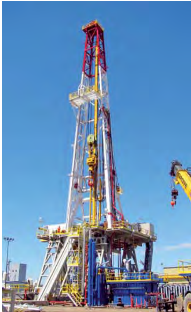
Nowoczesna, samobieżna wiertnia, może szybko dotrzeć drogami publicznymi do miejsca, w którym będzie pracować.
