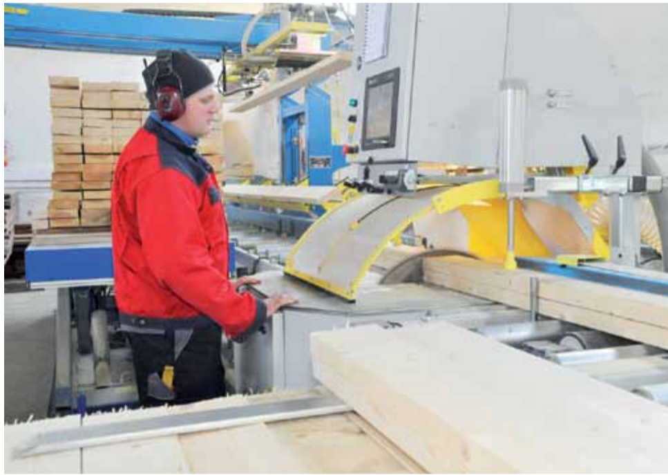
Na hali produkcyjnej goście mieli okazję obejrzeć pokaz pracy piły, która tnie drewno konstrukcyjne pod dowolnym kątem.
