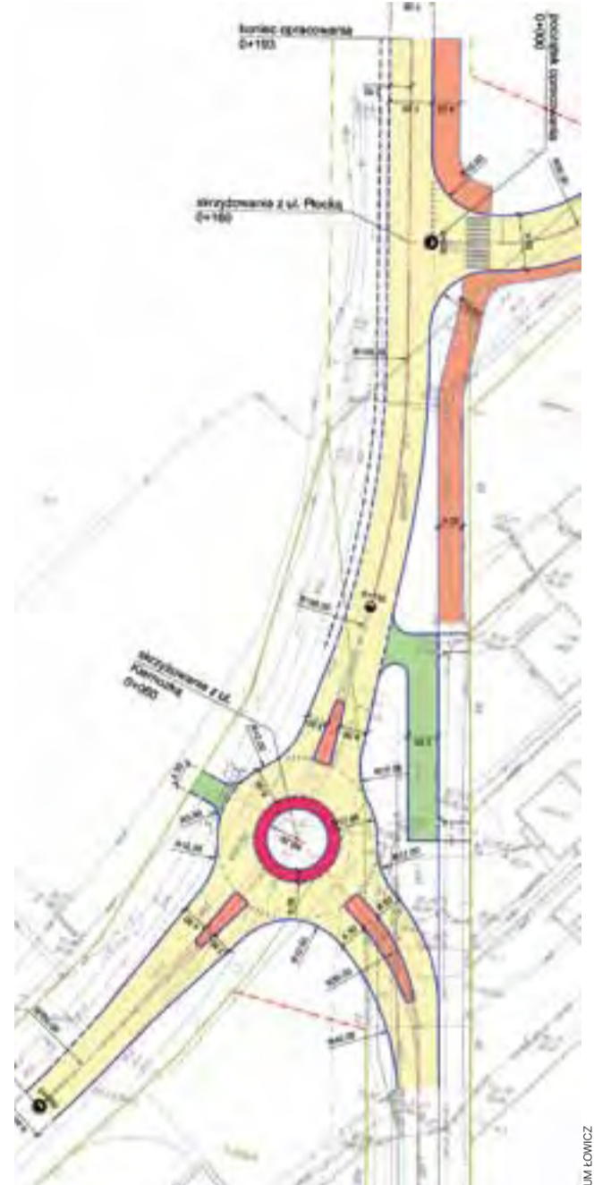
Koncepcja przebudowy skrzyżowania ulic Płockiej i Kiernozkiej na skrzyżowanie ruchu okrężnego (rondo) oraz skrzyżowania z nowym odcinkiem ul. Płockiej prowadzącym do ul. Małszyce.
