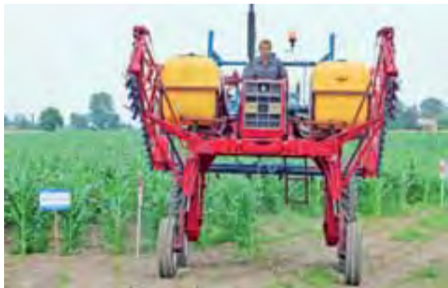
Pierwsze skojarzenie – Transformers. A to po prostu opryskiwacz na ciągniku szcudłowym, służącym do pracy na uprawach kukurydzy.
