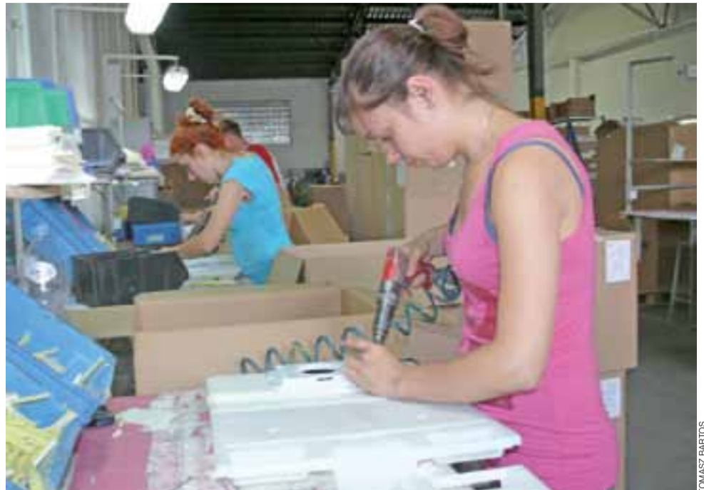
Stanowiska pracy w nowej lokalizacji zakładu Inter-Log. Pracownica montuje wentylator do jednego z paneli zamrażarki.
