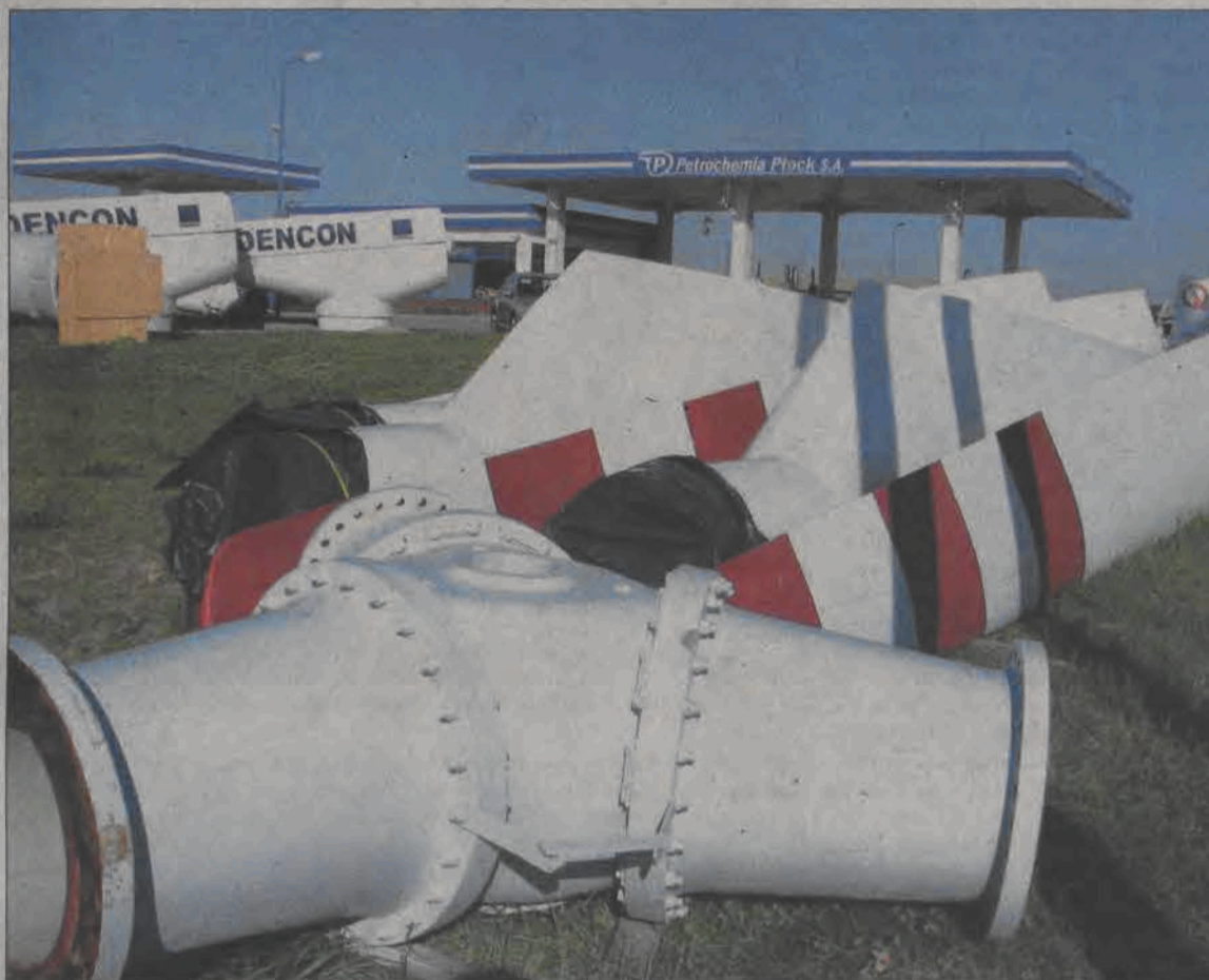
Elementy wiatraka można zobaczyć obecnie przy stacji paliw Jerzego Wieteski w Goleńsku. Na pierwszym planie element, do którego montowane będą widoczne obok skrzydła.
