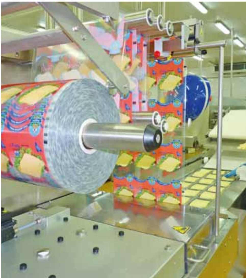
Maszyna do krojenia sera nie tylko go kroi, waży w identyczne wagowo porcje, ale i od razu go pakuje.
