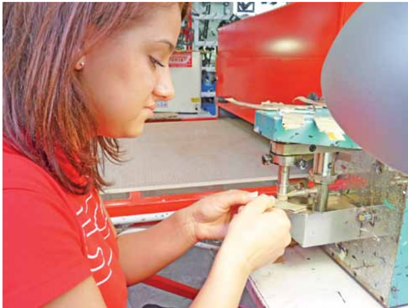
Proces produkcji etui przebiega w sposób precyzyjny, wszystkie jego elementy muszą do siebie idealnie pasować. Renata Płuska, widoczna na zdjęciu, maluje brzozy zszytych fragmentów skóry, które będą tworzyć zapięcie etui.
