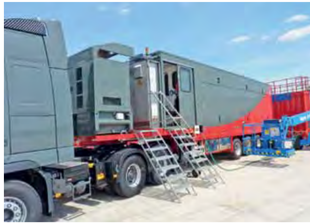
Samobieżne laboratorium umożliwi kontrolę procesu szczelinowania.
