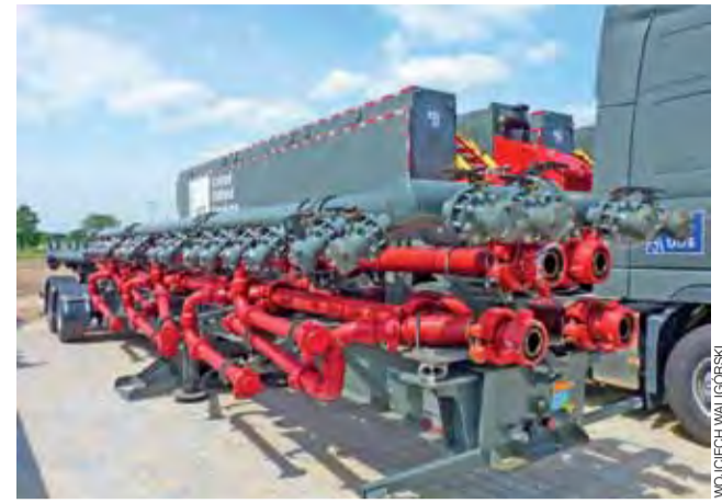
Mani-fold – urządzenie do rozdzielania płuczki na kilka pomp.
