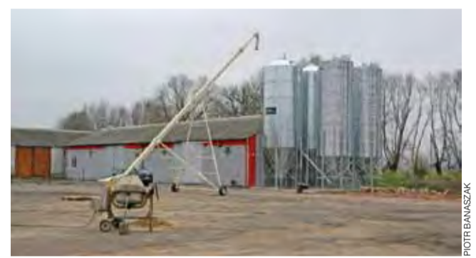
Podajnik ślimakowy umożliwia łatwe pobieranie surowców z silosów.
