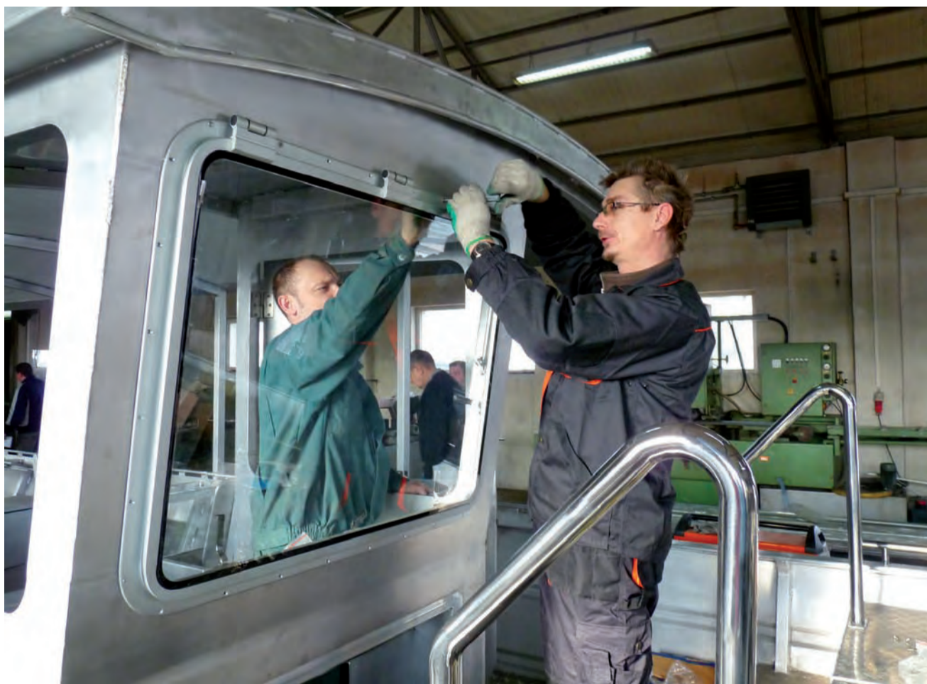
Kadłub łodzi jest już gotowy. A tak wygląda montowanie szyb w sterówce.
